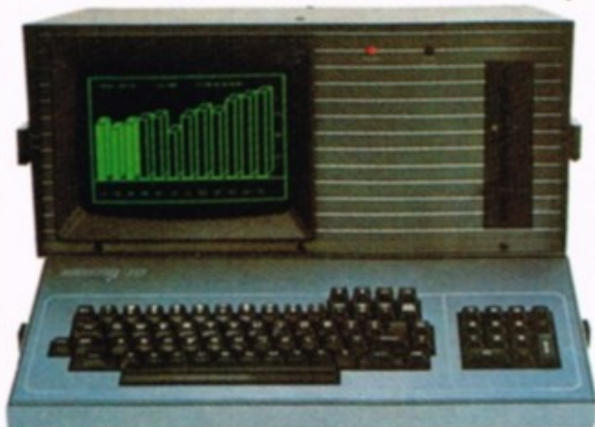
KAYPRO II, con 2 unidades de discos de 200 kbytes por unidad.
